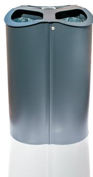
Il cestino è costituito da 3 contenitori semicircolari di raggio 207 mm uniti tra loro a formare un corpo unico in lamiera zincata Sendzimir sagomata al laser e pressopiegata sp. 15/10 mm con la possibilità di apporre su ogni lamiera il logo personalizzato sagomato o di fare delle feritoie mediante il taglio laser (versione antiterrorismo). Il fondello di ogni contenitore è in lamiera zincata sp. 3 mm.
